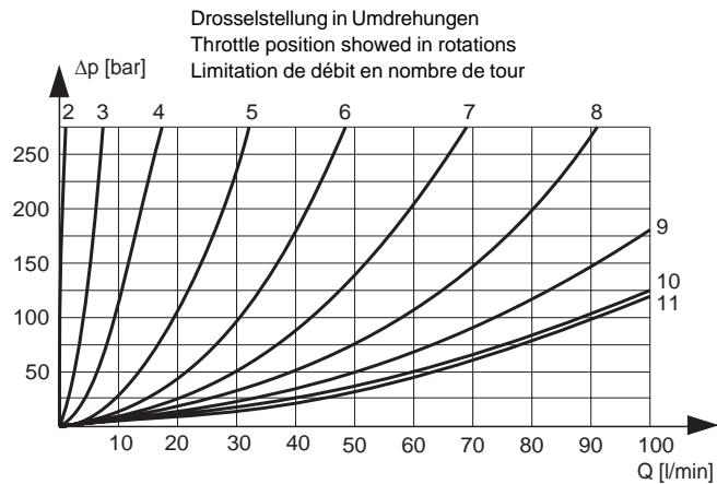
**Δp bei geöffnetem Rückschlagventil**
