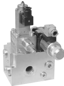
Pumpenträger, Kupplung, Innenzahnradpumpe, Druckölfilterung mit elektrischer Verschmutzungsanzeige, proportionale Drucksteuerung und Ansteuerung der Nachsaugventile sind in einer äußerst kompakten Einheit zusammengefaßt.
